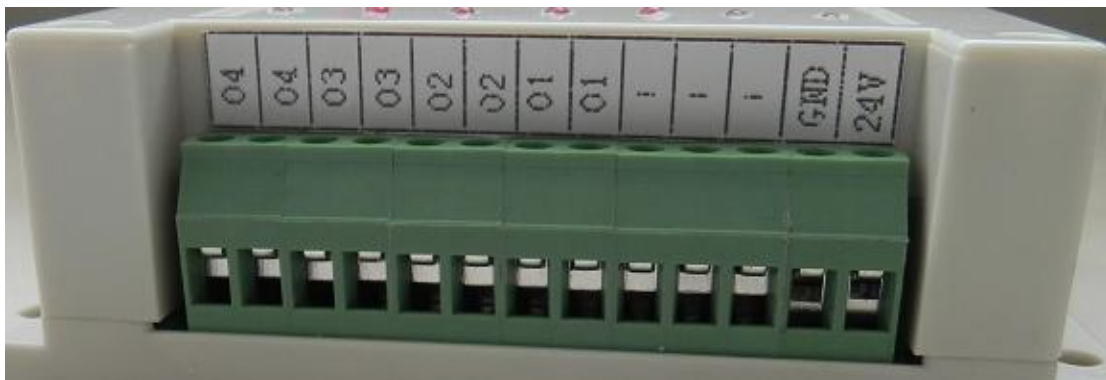
图二：COM1-开关输出及电源接线端子
